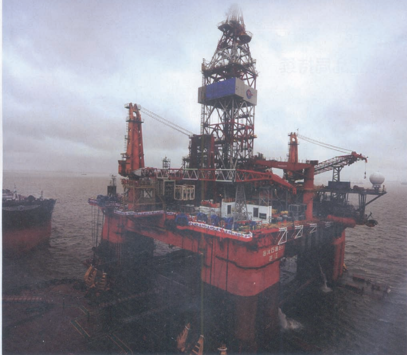
造价近 60 亿元的“海洋石油 981”钻井平台，能抵御南海 200 年一遇的波浪载荷。
