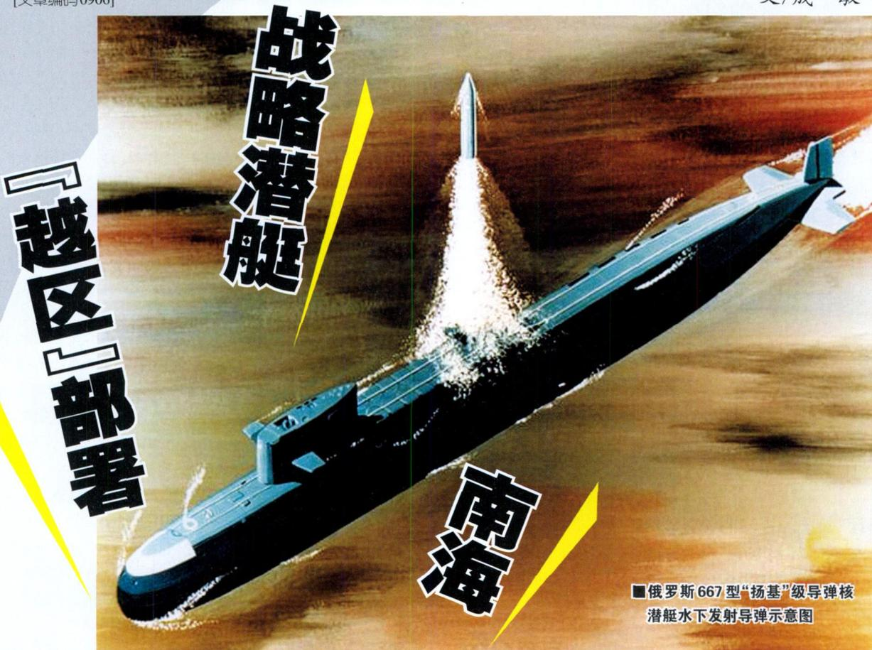
俄罗斯667型“扬基”级导弹核潜艇水下发射导弹示意图
